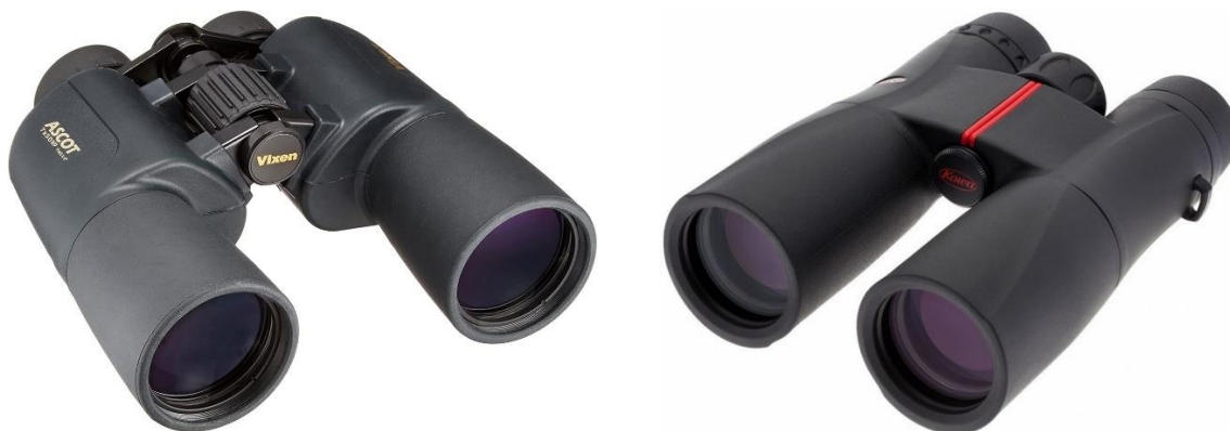
Εικ. 8: Κιάλια με κλασική (porro prism) και «κόμπακτ» σχεδίαση (roof prism) κατάλληλα για εύκολη παρατήρηση του ουρανού. Συνήθως έχουν φακούς από 40mm ως 60mm, με καταλληλότερες μεγεθύνσεις 7x ως 12x. Πολλοί θεωρούν ως ιδανικό ένα ζευγάρι 10x50mm.
